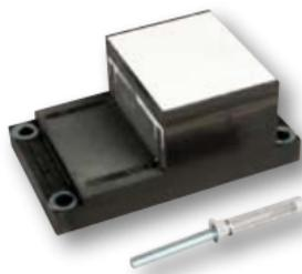
UMP-ALU-TRI est calée au mortier colle et maintenue en place par fixations mécaniques. Après séchage, celles-ci sont serrées, puis l'isolant est placé et revêtu du système enduit base-finition. Cette plaque permet la fixation d'éléments lourds sans ponts thermiques.
