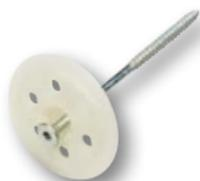
STR H est une cheville à visser pour les supports bois avec un plateau de 60 mm, et une vis bois de 6 mm pour la fixation des masses isolantes sur support Maison Ossature Bois grâce à l'outil STR-Tool. La réservation dans la tête de cheville est obturée à l'aide du bouchon en polystyrène.
