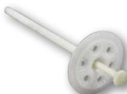
**EJOTerm NTK U** est une cheille plastique à clou nylon, à plateau de 60 mm, de diamètre de percement de 8 mm pour les isolants de 50 à 190 mm. La fixation se fait à fleur de l'isolant, selon les plans de chevillage disponibles en page 39.
