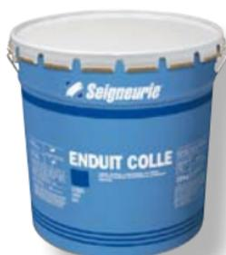
**Enduit Colle** est une pâte en phase aqueuse dans laquelle il faut ajouter 25 à 30 % de ciment gris CEM II/A. Il est utilisé pour le collage et le calage des panneaux isolants, à raison d'au moins 3 à 3,5 kg de produit préparé, en plein, par plots ou par boudins.
