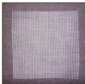
Fibre de verre prédécoupée placée à la jonction des profilés aluminium.
