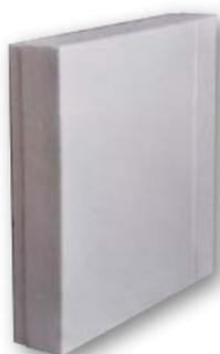
**Panneau Iso 15/38 SV** est une plaque d'isolant avec un  $\lambda$  de 0,038 W/m\*K et une masse volumique de 15 kg/m<sup>3</sup>. Les dimensions sont 500x500 mm pour une épaisseur de 60 à 150 mm. Elle est rainurée sur les 4 côtés, avec un épaulement, afin de recevoir les profilés PVC dans le cadre des systèmes Revitherm/Revithermono SV.
