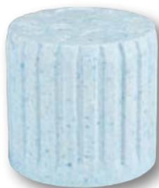
Zyrillo est une pièce en polystyrène haute densité de diamètre 70 ou 125 mm. Il se pose par découpage de la masse isolante, puis par collage. Après séchage, il est revêtu du système enduit base-finition. La fixation des pièces rapportées de type «pluviale» se fait à l'aide d'une vis à bois.
