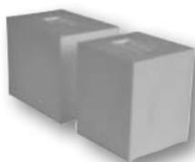
Pièce en PSE de masse volumique 170 kg/m<sup>3</sup>. De dimensions 98x98 mm ou 138x98mm et d'épaisseur 60 à 300 mm. Elle est utilisée pour la reprise de charge en compression.
