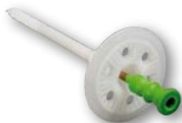
**EJOTerm NT U** est une cheville plastique à clou métal, à plateau de 60 mm, de diamètre de percement de 8 mm, pour les isolants de 200 à 260 mm. Elles sont fixées à fleur de l'isolant, selon les plans de chevillages disponibles en page 39.
