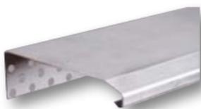
**Profilé de Couronnement NP** en aluminium 10/10<sup>e</sup>, en longueur de 2 m ou 2,50 m, partie supérieure non perforée, pour isolant d'épaisseur de 30 à 200 mm. Il est fixé tous les 30 cm.
