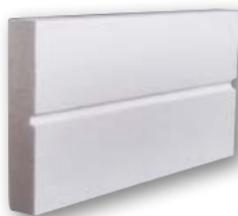
**Panneau Iso Bossage** est une plaque d'isolant de dimensions 500x1000 mm ou 600x1200 mm et d'épaisseur de 60 à 300 mm qui intègre une rainure centrale trapézoïdale 15x18x28 mm. Utilisé dans le cadre des systèmes Revitherm/Revithermono Collé et CC. Ce système permet la réalisation de joints creux dans l'épaisseur du système d'ITE.
