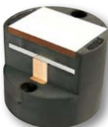
Cylindre UMP-ALU-Z est une platine circulaire de diamètre 125 mm qui se pose par découpage de la masse isolante puis par collage au mortier et fixation mécanique. Les réservations de celles-ci sont obturées avec des bouchons PSE. Elle est revêtue du système enduit base-finition et permet la fixation d'éléments de charges moyennes sans ponts thermiques.
