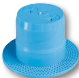
Eldoline PA boîtier en polyamide destiné à recevoir des équipements électriques de type «prise de courant». Il se pose par découpage de la masse isolante, puis par collage. Il permet la fixation d'éléments électriques en limitant les ponts thermiques.
