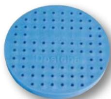
DoRondo est une pièce en polypropylène de diamètre 90 mm. Il se pose par découpage de la masse isolante et par collage. Après séchage, il est revêtu du système enduit base-finition. La fixation des pièces rapportées de type « plaque de N° de rue » se fait à l'aide de vis à bois.
