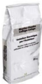
**Mortier-Poudre Collage-Calage** est une poudre à base de ciment à gâcher avec environ 27% d'eau (E/M = 0,27) utilisée pour le collage et le calage des panneaux isolants. Il s'applique à raison de 3 kg/m<sup>2</sup> (produit mélangé), en plein, par plots ou par boudins.
